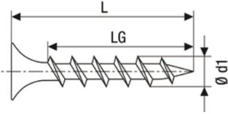
**GIX<sup>®</sup> Typ-B, Schnellbauschraube, Trompetenkopf, Kreuzschlitz H, Grobgewinde**
