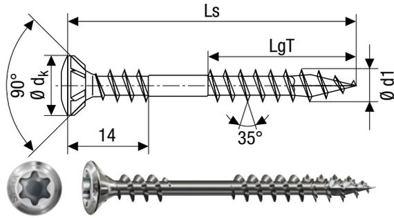
**Fassadenschraube, Linsensenkkopf, Magaziniert**
