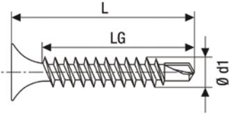
**GIX<sup>®</sup> Typ-D, Schnellbauschraube, Trompetenkopf, Kreuzschlitz H, Blechgewinde**
