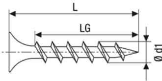
**GIX<sup>®</sup> Typ-B, Schnellbauschraube, Trompetenkopf, Magazinert, Kreuzschlitz H, Grobgewinde**
