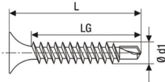
**GIX<sup>®</sup> Typ-D, Schnellbauschraube, Trompetenkopf, Magazinert, Kreuzschlitz H, Blechgewinde**
