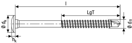
**FEX – Kopplungsschraube, Flachkopf mit Zentrieransatz, T-STAR plus, Spezialgewinde**
