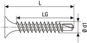
**GIX<sup>®</sup> Typ-D, Schnellbauschraube, Trompetenkopf, Magazinisiert, Kreuzschlitz H, Blechgewinde**
