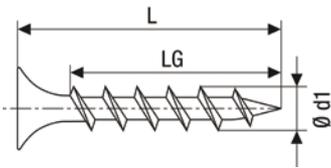
**GIX<sup>®</sup> Typ-B, Schnellbauschraube, Trompetenkopf, Magazinisiert, Kreuzschlitz H, Grobgewinde**
